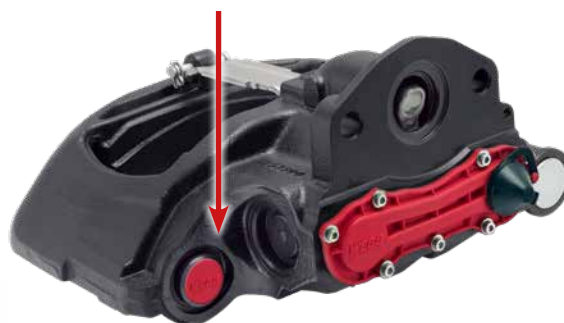
NS225 - no bolts visible
